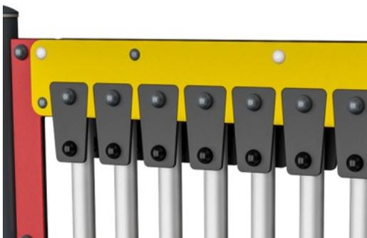
Membrány se skládají z pogumovaného materiálu odolného proti tření, s kvalitou dopravního pásu s vynikající odolností proti UV záření. Vestavěné je čtyřvrstvé pancéřování z tkaného polyesteru. Pancéřování a dvě povrchové vrstvy mají celkovou tloušťku 9 mm.
