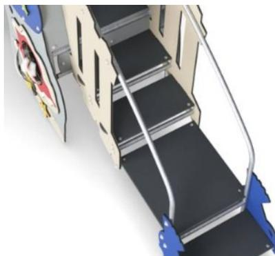
Alle Böden bestehen aus HPL-Hochdrucklaminat mit einer Stärke von 17,8 mm und rutschfester Oberflächenstruktur nach EN 438-6. Die KOMPAN HPL-Böden sind unter allen Wetterbedingungen äußerst verschleißfest.
