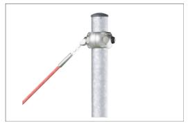
Corocord Smart Schellen sind bis ins kleinste Detail durchdacht, um eine überragende Flexibilität aus hochwertigem Aluminium zu gewährleisten. Die Smart Schellen werden mit vier Stahlbolzen um die Pfosten herum befestigt. Nicht verwendete Befestigungspunkte werden mit Kunststoff-Kappen verschlossen.
