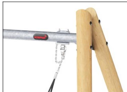
Crochets de suspension KOMPAN robustes en acier inoxydable avec fonction anti-torsion. Les cintres sont fixés à la traverse sur un support soudé avec deux boulons, les roulements sont intégrés avec du lubrifiant silicone et ne nécessitent aucune lubrification supplémentaire.
