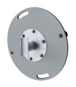
La boîtier de palier est fait d'acier galvanisé par immersion à chaud. L'arbre de roulement est fabriqué en acier inoxydable AISI304. Le roulement est, lui, fabriqué à partir de polyoxyméthylène (POM), une résine thermoplastique dotée d'une grande rigidité, un faible frottement, et une excellente stabilité dimensionnelle.
