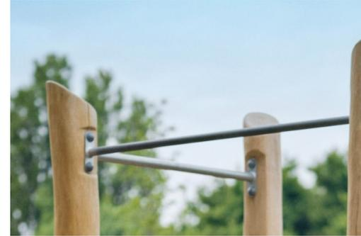
Die Klimmzugstange ist aus einem HDG-Stahlrohr mit einem Durchmesser von 32 mm gefertigt. Das Klimmzugstange ist 1080 mm breit und befindet sich 2300 mm über dem Boden.
