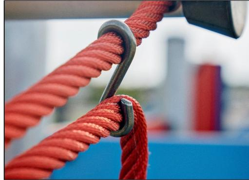
Corocord“S”扣在 Corocord 产品中作为通用连接。用特殊的液压机将带有圆形边缘的 8mm 不锈钢条压在绳索周围，使其成为理想的连接部件。其安全、耐用且防破坏，适用于攀爬网游戏结构中的典型游戏运动。
