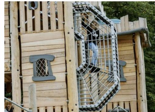
Der Drahtrahmentunnel ist aus feuerverzinktem Qualitätsstahl gefertigt. Corocord 16 mm Seile aus UV-stabilisierten PES-Seilsträngen mit innerer Stahlseilverstärkung. Das Polyestergerüst besteht aus +95 % Post-Consumer-Materialien und wird induktiv auf jede Litze aufgeschmolzen. Die Seile sind sehr verschleiss- und vandalismusbeständig und können bei Bedarf vor Ort ausgetauscht werden.
