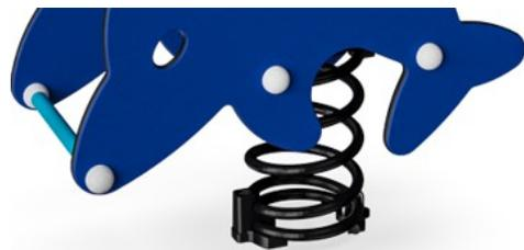
KOMPAN Federn bestehen aus hochwertigem Federstahl nach EN 10270-1. Die Federn werden durch Phosphatierung gereinigt, bevor sie mit einer Epoxid-Grundierung und Polyester-Beschichtung überzogen werden. Die Federn werden mit speziellen Klemmschutz-Elementen angebracht, um für höchste Sicherheit und eine hohe Lebensdauer zu sorgen.
