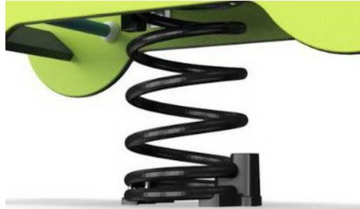
Los muelles KOMPAN están hechos de acero de resorte de alta calidad según EN10270. Los muelles se limpian mediante fosfatación antes de pintarlos con una imprimación epoxi y un recubrimiento de poliéster en polvo como acabado superior. Los muelles se fijan mediante accesorios anti-pellizcos únicos para máxima seguridad y larga vida útil.
