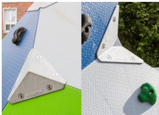
优质无铅铝压铸角架。角支架的边缘圆润，沉头不锈钢螺钉。在日晒环境中，可选配粉末涂层工艺，以减少角架的热吸收。
