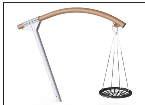
L'altalena GIANT è disponibile in più combinazioni attraverso il configuratore digitale del prodotto KOMPAN: acciaio zincato con finitura superiore verniciata a polvere opzionale in colore verde lime, sospensioni a catena in corda o acciaio inossidabile, ancoraggio inground o surface, e seggiolino a cesto in corda o rotostampato.
