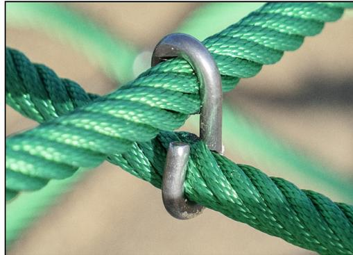
Las abrazaderas Corocord 'S' se utilizan como conexiones universales en los productos Corocord. Las varillas de acero inoxidable de 8 mm con bordes redondeados se presionan alrededor de las cuerdas con una prensa hidráulica especial, lo que las convierte en el conector ideal: seguro, duradero y a prueba de vandalismo, todo mientras permite el movimiento típico de las estructuras de juego de la cuerda.
