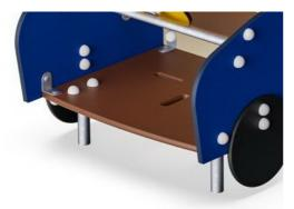
Los asientos están hechos de madera contrachapada de 22 mm de espesor hecha de aliso y madera de pino. Ambos lados están cubiertos por 2 capas de película fenólica con patrón de red antideslizante. Todos los bordes de corte están sellados con pintura para garantizar una larga vida útil.
