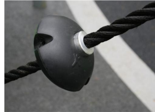
绳索由防紫外线的 PES 绳股制成，并带有内部缆增强件。聚酯包裹的绳股经过感应处理，融化到每根单独的丝束上，以获得优异的耐磨性和抗撕裂性。
