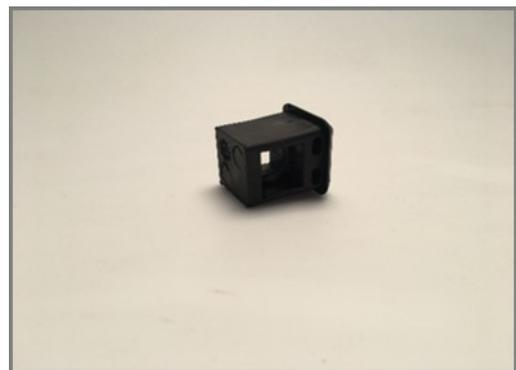
Cada panel tiene 4 conectores de vulcanizados termoplásticos que conectan los paneles a los postes. Los conectores reducen la vibración y, por lo tanto, reducen el nivel de ruido. Los conectores también simplificarán la instalación, ya que vienen con tuercas premontadas.
