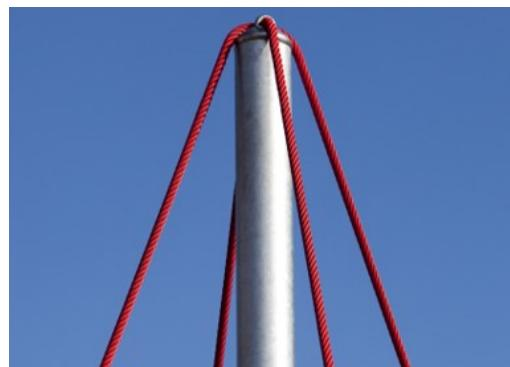
Střed sítě je podepřen stožárem, vyrobeným z vysoko kvalitní bezešvé oceli. Konstrukce stožáru jako volné podpěry je staticky výhodná a vyrovňává oscilaci celé sítě. Stožáry jsou standardně pozinkovány v horké lázni a na přání mohou být povrchově upraveny práškovou barvou.
