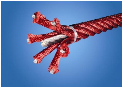
Lana jsou varobena z UV stabilizovaných PES pramenů s vnitřní výztuží z ocelových lan. Polyesterová příze je z více než 95 % tvořena post-spotřebními materiály a je indukčně natavena na každé vlákno. Lana jsou vysoce odolná proti opotřebení a vandalismu a v případě potřeby je lze vyměnit na místě.
