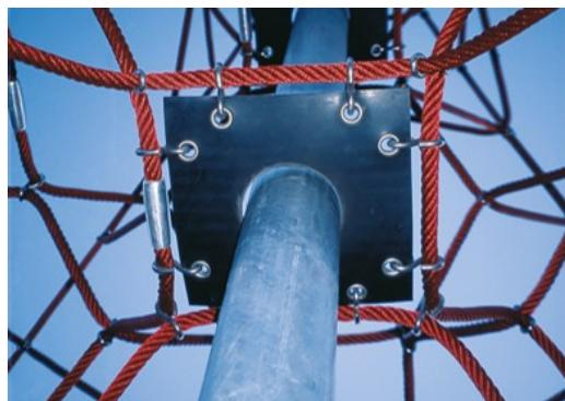
Membrány Corocord jsou vyrobeny z oděruvzdorného pogumovaného materiálu v kvalitě používané u pásových přepravníků a mají vynikající odolnost vůči UV záření. Jsou testovány a splňují nařízení REACH pro polycylické aromatické uhlvodíkyl (PAH). Je do nich integrováno čtyřvrstvé vyztužení ze tkaného polyesteru. S tímto vyztužením a dvěma povrchovými vrstvami mají celkovou tloušťku 7,5 mm.
