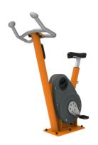
Il tubo anteriore per la struttura è realizzato in tubo d'acciaio S235 zincato a caldo con le seguenti dimensioni Ø76,1x3,6 mm e con una verniciatura a polvere di classe di corrosione C3 secondo ISO12944-2.
