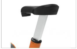
La seduta è realizzata in PUR morbido stampato ad iniezione, con un inserto interno in acciaio S235 verniciato a polvere. L'utente può scegliere tra 9 diverse altezze della seduta, comprese tra 845 mm e 995 mm. La seduta consente agli utenti con un'altezza compresa tra 150 cm e 195 cm di utilizzare comodamente la cyclette.
