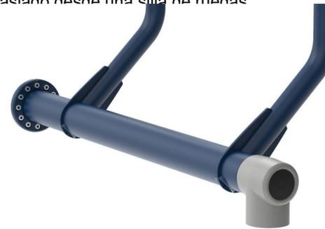
El eje de entrada es de  $\varnothing$ 101,3 x 2,9 mm S355 de acero galvanizado en caliente y pintado en polvo. La caja de rodamientos es de aluminio fundido (EN AB-44100 / EN AB-AISi12(a)) con rodamientos de bolas sellados autoalineables. Una construcción extremadamente fuerte y duradera.
