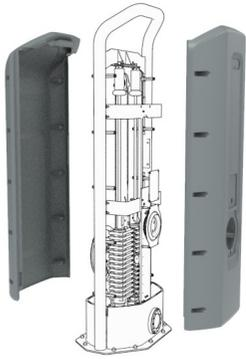
La carcasa protege todas las partes móviles de vandalismo y atrapamientos. La carcasa está hecha de LLDPE rotomoldeado de 5 mm, polietileno lineal de baja densidad, con excelente resistencia al impacto.
