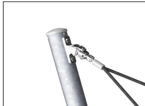
Les supports de balançoire sont constitués de supports en acier inoxydable et peuvent se déplacer sur deux axes. Les roulements de bride sont enrichis en silicone pour rendre la suspension sans entretien. Au niveau de la fixation de la corde, il y a une fonction anti-torsion rotative qui empêche l'enroulement des cordes.
