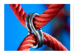
Corocord"S" 扣在 Corocord 产品中作为通用连接。 用特殊的液压机将带有圆形边缘的 8mm 不锈钢 条压在绳索周围,使其成为理想的连接部件。其 安全、耐用且防破坏,适用于攀爬网游戏结构中 的典型游戏运动。
