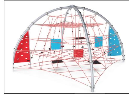
Los arcos doblados sostienen la estructura de red tensada sin elementos de sujeción adicionales. Por lo tanto, los arcos se producen de acero inoxidable de alto grado para permitir el movimiento de la red en la superficie de los arcos de acero. La superficie se trata para hacerla brillante.
