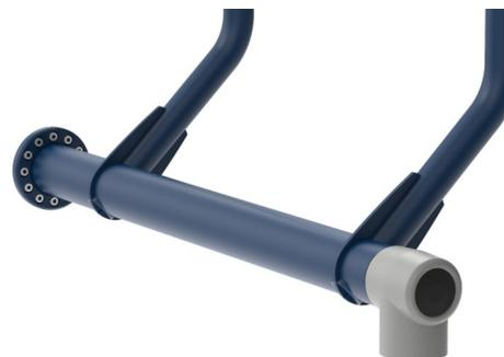
Die Antriebswelle besteht aus Ø101,3 x 2,9mm S355 feuerverzinktem und pulverbeschichtetem Stahl. Das Lagergehäuse ist aus Aluminiumguss (EN AB-44100 / EN AB-ALSi12(a)) mit selbstausrichtenden, abgedichteten Kugellagern. Eine extrem starke und langlebige Konstruktion
