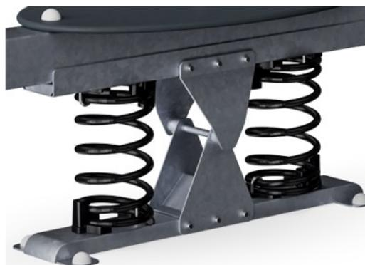
Le molle KOMPAN sono realizzate con acciaio per molle di alta qualità secondo EN10270. Le molle vengono pulite mediante fosfatazione prima di essere verniciate con un primer epossidico e un rivestimento in polvere di poliestere come finitura superiore. Le molle sono fissate da esclusivi raccordi anti pizzico per la massima sicurezza e lunga durata.
