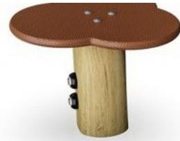
I gradini sono realizzati in multistrato con spessore 21,5 mm in legno di ontano e pino. Entrambi i lati sono coperti da 2 strati di film fenolico con motivo a rete antiscivolo. Tutti i taglianti sono sigillati con vernice per garantire una lunga durata.
