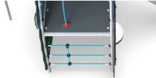
Las redes de escalada están hechas de cuerda de PP estabilizada contra los rayos UV con refuerzo interno de cable de acero. El cable está tratado por inducción para obtener la máxima fijación entre el acero y el cable, lo que proporciona una excelente resistencia al desgaste. Todos los conectores de cable están hechos de material PA 100% reciclable.
