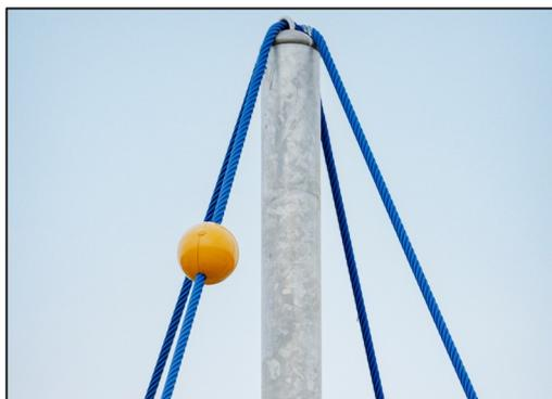
Le centre du Pyracord est constitué d'un mât en acier d'un tenant de haute qualité. La structure du mât en tant que support oscillant améliore la stabilité et compense les oscillations du Pyracord. Les mâts standard sont galvanisés à chaud mais il est possible de les personnaliser avec un revêtement thermolaqué en supplément.
