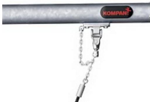
KOMPAN Schwerlast-Schaukelaufhängungen aus rostfreiem Stahl mit Verdrehssicherung. Die Aufhängungen sind mit zwei Bolzen am Querträger auf einer geschweißten Halterung befestigt. Die Lager sind mit Silikonschmiermittel versehen und benötigen keine weitere Schmierung.
