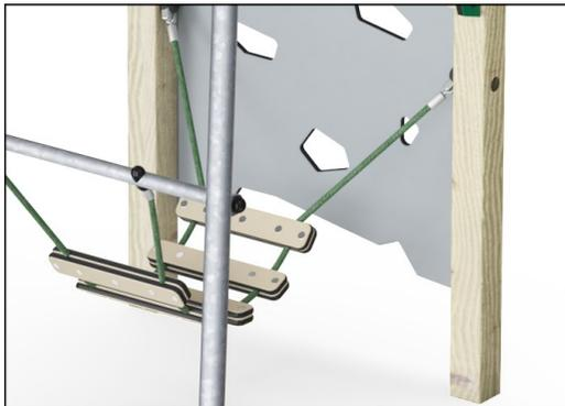
Corocord-Seile aus UV-stabilisierten PES-Seilsträngen mit innerer Stahlseilverstärkung. Das Polyestergerüst wird aus +95 % Post-Consumer-Materialien hergestellt und induktiv auf jede Litze aufgeschmolzen. PES hat eine hohe Festigkeit mit ausgezeichneter Beständigkeit gegen Abrieb und UV-Strahlung. Die Hängematten-Plattformen bestehen aus EcoCore™ HDPE aus +95 % Post-Consumer-Material.
