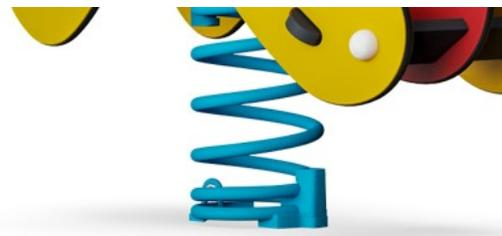
Le molle KOMPAN sono realizzate con acciaio per molle di alta qualità secondo EN10270. Le molle vengono pulite mediante fosfatazione prima di essere verniciate con un primer epossidico e un rivestimento in polvere di poliestere come finitura superiore. Le molle sono fissate da esclusivi raccordi anti pizzico per la massima sicurezza e lunga durata.
