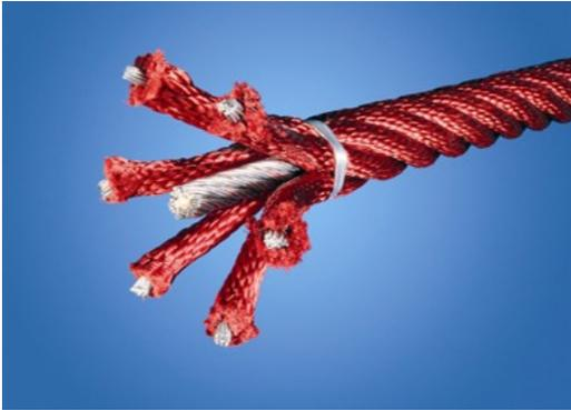
绳索有六股钢丝和一根钢丝芯。每根丝束都用 PES 纱紧密包裹，然后将其融化到每根单独的丝束上。在最初的摩擦力去除了表面纤维之后，保留了较硬的 PES 涂层以保护每根股绳，从而使绳索具有极高的耐磨性和防破坏性。
