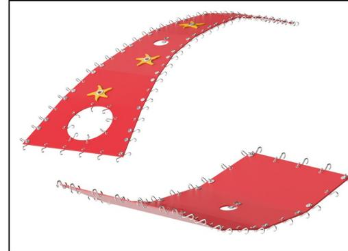
Die Corocord Membranen bestehen aus rutschfestem, gummiertem Material in Förderband-Qualität, das eine exzellente UV-Beständigkeit aufweist. Die geprüfte Konformität mit den REACH-Anforderungen für PAK ist gegeben. In die Membranen ist eine vierlagige Armierung aus gewebtem Polyester eingebettet. Die Armierung und die doppelte Oberflächenschicht ergeben eine Gesamtstärke von 8 mm.
