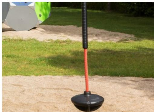
Le siège spécial est fait d'un insert en acier inoxydable recouvert d'une couche de caoutchouc polyuréthane (PUR) souple. Le siège a été testé contre les chocs et respecte toutes les normes internationales en vigueur pour les aires de jeux. La corde est dotée d'une poignée ergonomique de 60 cm de long moulée en caoutchouc PUR.
