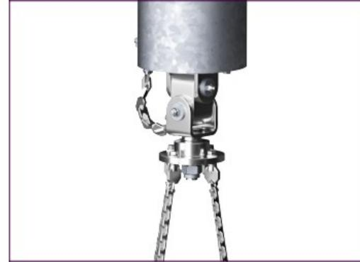
Gancio girevole a 360 gradi dal design unico realizzato in acciaio inossidabile. Le parti mobili del gancio oscillante sono sigillate e lubrificate a vita. Il sistema di aggancio è dotato di una catena di sicurezza per evitare che il gancio di oscillazione cada se danneggiato.
