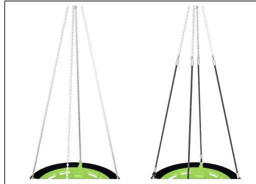
Le sospensioni del seggiolino sono disponibili con catena o fune in acciaio inossidabile. Le corde sono realizzate in PA stabilizzato ai raggi UV con rinforzo interno in cavo d'acciaio. La corda è trattata per induzione al fine di creare una forte connessione tra acciaio e corda per garantire una buona resistenza all'usura.
