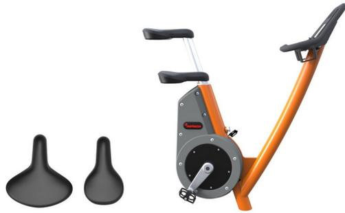
Der Sattel besteht aus Polyurethan-Gummi und ist mit einer Stahleinlageplatte versehen, die ihn mit der Sattelstütze aus Aluminium verbindet. Der Sattel kann mit Hilfe eines Pop-Pins aus Edelstahl auf 13 verschiedene Höhen eingestellt werden.
