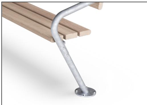
Les surfaces en acier sont galvanisées à chaud à l'intérieur et à l'extérieur avec du zinc sans plomb. La galvanisation a une excellente résistance à la corrosion dans les environnements extérieurs et nécessite peu d'entretien. Les pièces en acier peint sont galvanisées à chaud avant thermocollage.
