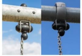
Die Schaukelaufhängungen bestehen aus einem hochwertigen und UV-beständigem Nylon (PA6) Gehäuse mit integrierten dauergeschmierten Kugellagern. Die höhenverstellbaren Ketten werden durch Edelstahl-Haken angebracht, die diebstahlgesichert und mit einem Anti-Überschlag-Gehäuse versehen sind. Alle Sitze mit zwei Kettenaufhängungen sind erhältlich mit Standard-/ oder Anti-Überschlag-Aufhängung.
