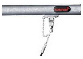
KOMPAN Schwerlast-Schaukelaufhängungen aus rostfreiem Stahl mit Verdrehsicherung. Die Aufhängungen sind mit zwei Bolzen am Querträger auf einer geschweißten Halterung befestigt. Die Lager sind mit Silikonschmiermittel versehen und benötigen keine weitere Schmierung.
