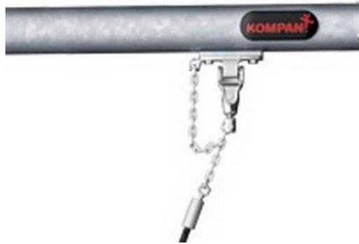
Colgadores de acero inoxidable de diseño resistente KOMPAN con función anti-torsión. Los soportes están unidos al poste transversal en un soporte soldado con dos pernos. Los cojinetes están incrustados con lubricante de silicona y no necesitan más lubricación.
