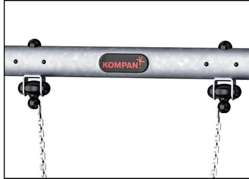
秋千吊架由高质量的 UV 稳定尼龙 (PA6) 外壳制成, 并带有集成的全寿命密封球轴承。高度可调节的链条由带有防盗蛇眼螺栓的不锈钢钩固定在可旋转的防扭外壳中。所有带有两个链条固定装置的座椅都可提供标准悬架或防缠绕悬架。
