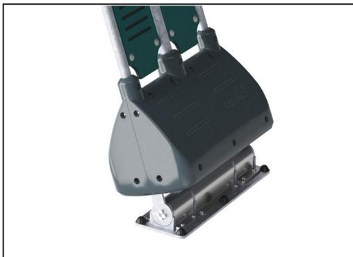
Die Schaukelbewegung vor und zurück wird durch ein hochbelastbares, skaliertes Doppelgummi-Torsionsfedererelement gesteuert. Das Gummielement gewährleistet eine sichere Bewegung und reduziert die Geschwindigkeit in Richtung der Turmplattformen. Die Basisabdeckung ist aus geformtem PE-Material mit hoher Schlagfestigkeit hergestellt.
