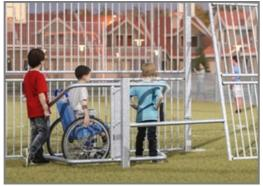
L'entrée pour fauteuil roulant est constituée de poteaux de 80 x 80 x 3 mm avec un tube de 48 mm de diamètre et de 2 charnières en acier inoxydable de 16 mm. L'ouverture mesure 95 cm de large et 112 cm de long, ce qui permettra aux personnes en fauteuil roulant d'entrer dans le MUGA, mais pas aux cyclomoteurs et autres véhicules motorisés.
