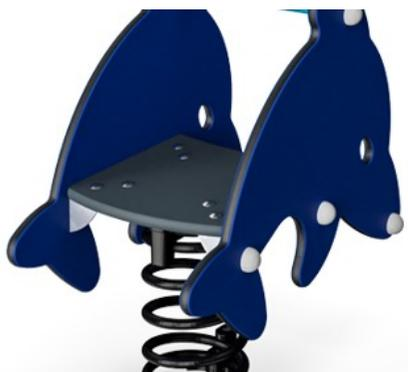
Le siège est fabriqué à partir d'un panneau Ekogrip®, qui se compose d'une base de PE de 15 mm d'épaisseur avec une couche de surface de 3 mm de caoutchouc souple pour un effet antidérapant.
