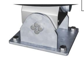
Le double élément ROSTA est fait de fer coulé et galvanisé par immersion à chaud avant d'être peint. L'élément ROSTA est une articulation élastique sans entretien, pouvant être déplacée avec une amplitude articulaire de 250° dans n'importe quelle direction. Les deux oscillations ont une rigidité différente de 45 %.
