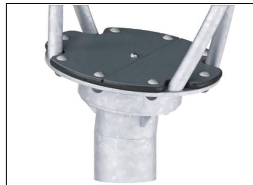
Die obere Platte ist eine Ekogrip®-Platte, die aus einer 15 mm dicken PE-Basis (Polyethylen) mit einer 3 mm dicken Deckschicht aus weichem Gummi mit Anti-Rutsch-Oberfläche besteht.
