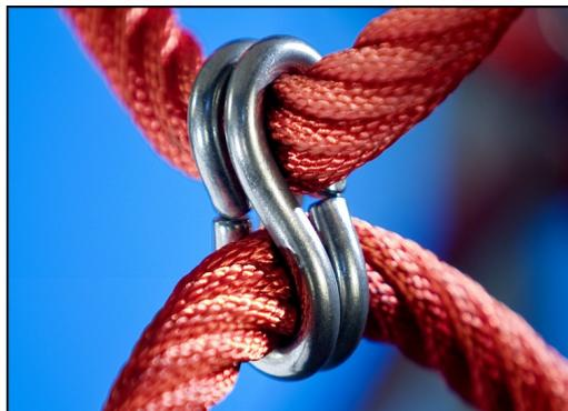
Las abrazaderas Corocord 'S' se utilizan como conexiones universales en los productos Corocord. Las varillas de acero inoxidable de 8 mm con bordes redondeados se presionan alrededor de las cuerdas con una prensa hidráulica especial, lo que las convierte en el conector ideal: seguro, duradero y a prueba de vandalismo, todo mientras permite el movimiento típico de las estructuras de juego de la cuerda.
