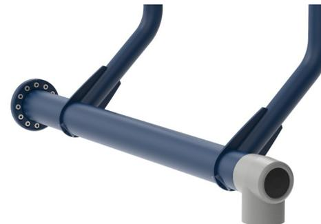
Die Antriebswelle besteht aus Ø101,3 x 2,9mm S355 feuerverzinktem und pulverbeschichtetem Stahl. Das Lagergehäuse ist aus Aluminiumguss (EN AB-44100 / EN AB-A1Si12(a)) mit selbstausrichtenden, abgedichteten Kugellagern. Eine extrem starke und langlebige Konstruktion
