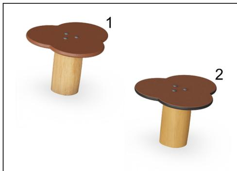
Les marchepieds sont disponibles en deux versions. Soit 1) contreplaqué d'une épaisseur de 21,5mm en bois d'aulne et de pin avec les deux faces recouvertes de 2 couches de film phénolique avec motif antidérapant ou 2) panneaux EcoCore HDPE.
