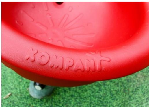
La toupie est fabriquée en polyéthylène (PE) recyclable. Le bol est moulé en une seule pièce avec un filetage en acier intégré et d'un drain d'eau afin d'assurer une durabilité élevée dans les climats du monde entier.
