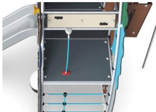
根据 EN 438-6，所有地板均由高压层压 HPL 制成，厚度为 17.8mm，表面防滑。KOMPAN HPL 具有很高的耐磨强度，可确保在所有气候下均具有较长的使用寿命。
