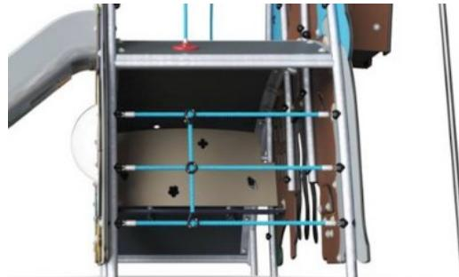
攀爬网由防紫外线的聚丙烯绳和内部的钢缆构成强化。对钢丝绳进行了感应处理，使其在钢和钢丝绳之间得到最大程度的固定，从而具有很好的耐磨性和抗撕裂性。所有的绳接头都是由 100% 可回收的 PA 材料制成。
