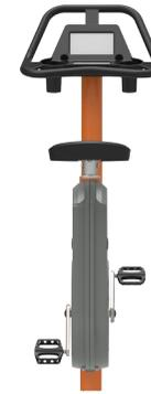
El factor Q de la bicicleta de brazo es de 175 mm, la manivela está hecha de acero inoxidable de 18 mm y conecta los brazos del pedal que son piezas de acero inoxidable fundido (grado 304). La longitud de los brazos del pedal es de 170 mm y los pedales están conectados con accesorios de bicicleta estándar.
